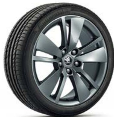
Zenith 3VO 071 498C HA7 EUR 351* viegļmetāla diskji 8.0J x 18" 235/45 R18 riepām ET44, metāliskā, antracīta krāsā ŠKODA oriģinālie aksesuāri
