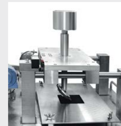
Jumta stieņu stiprinājumu slodzes tests
